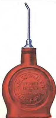
Ein wunderbarer, kleiner Öler mit ganz schlanker, eleganter Auslaufspitze. Die Auslaufspitze ist mit einem patentierten Rückschlagventil versehen, das sich durch Druck auf den Behälter öffnet und sich bei Nachlassen des Druckes dicht schliesst. Der Behälter ist durchsichtig, so dass der Inhalt stets zu erkennen ist.
