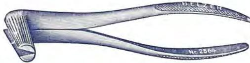
Mit der **Polklemmenzange** reinigt man die Innenwände der Polklemmen, um wieder guten Kontakt zu bekommen. Ausserdem dient die Zange zum Aufweiten der Polklemmen. **Mit langen, spitz-zulaufenden Backen. Auch für kleine Polklemmen passend.**
