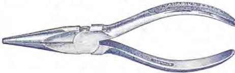
Mit Drahtschneider für gehärteten Stahl Draht. Die beliebte Montagezange für Elektro- und Telefonmonteure.
