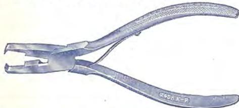
Eine Abzwickzange mit Seiten- und Vorschneider, sowie Flachzange, für Präzisionsarbeiten, wo gewöhnliche Seiten- und Vorschneider zu breit sind.
