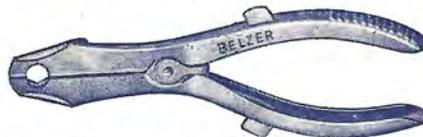
Diese Zange dient zum Einsetzen der zweiteiligen Ventilfederhalter. Die Halter werden in die Zange und dann auf den Ventilschaft geklemmt. Durch eine Feder drückt die Zange die Halter fest an den Ventilschaft, ohne dass man die Zange festhält. Beide Hände sind also für weitere Arbeiten frei.
