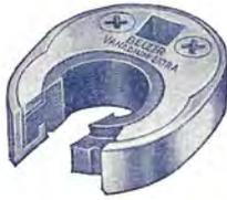
Schlitzweite für Rohre bis höchstens 13,5 mm (1/2") Aussendurchmesser
