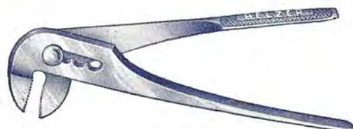
Mit **Drahtschneider** und 4 Verstellöchern. Schwer fassbare Muttern und runde Teile können mit dieser Zange bequem und sicher gefasst werden. Durch den gebogenen Kopf über die hohe Kante wird ein grosses Widerstandsmoment erreicht.
