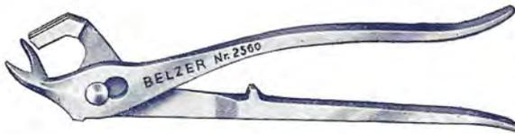
Diese **Polklemmenabhebezange** mit Schaber hat eine grosse Hebekraft, so dass noch so festsitzende Polklemmen leicht abgehoben werden können, ohne die Batterie dabei zu beschädigen. Die Zange ist zum Auseinandernehmen und jeder Schenkel kann dann als Schaber benutzt werden, der Schenkel mit der Gabel als Polschaber und derjenige mit dem gerieften Schaberende zum Reinigen der Innenwände der Polklemmen und anderer Kontakte.
