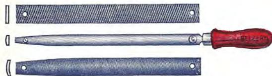
bestehend aus 4 Stück Stahlfeilenblättern mit schräg hinterschnittenen Zähnen und Spanbrecher, sowie einem aluminiumgespritzten Halter mit BELZERYL-Heft.
